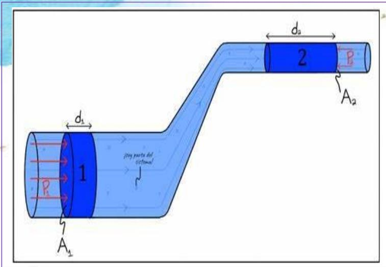
**TEOREMA DE BERNOULLI:** En un fluido ideal circulando en estacionariamente por un conducto, la energía mecánica por unidad de volumen del fluido es constante en todos los tramos del tubo, sin importar que tengan distinta sección transversal de área y altura.
