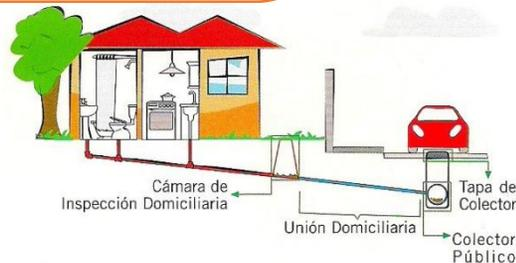
Esquema de Instalación de Alcantarillado
