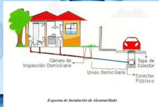
Esquema de Instalación de Alcantarillado
