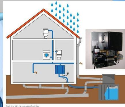
Instalación de aguas pluviales.
