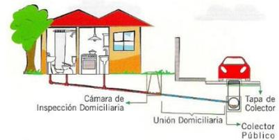
Esquema de Instalación de Alcantarillado
