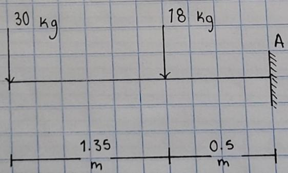
$$M_a = (18 \text{ kg} \cdot 0.5 \text{ m}) + (30 \text{ kg} \cdot 1.85 \text{ m}) = 0$$
