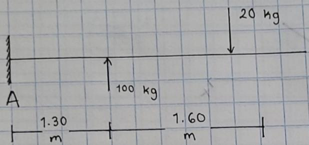
$$M_a = (100 \text{ kg} \cdot 1.30 \text{ m}) - (20 \text{ kg} \cdot 2.90 \text{ m}) = 0$$
