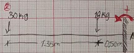
$$M_A = (18 \text{ kg} \cdot 0.50 \text{ m}) + (30 \text{ kg} \cdot 1.85 \text{ m}) = 0$$
