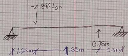
$$M_A = (-2.898 \text{ ton} \cdot 1.05 \text{ m}) + (0.75 \text{ m} \cdot 2.60 \text{ m})$$
