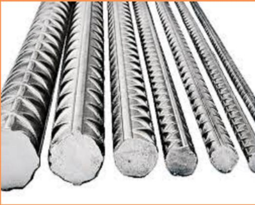
Varilla corrugada de acero. Desde el no. 3 (3/8") al no. 12 (1 1/2"). Ésta ha sido especialmente fabricada para usarse como refuerzo en el concreto. La superficie de la varilla está provista de rebabas o salientes llamadas corrugaciones, las cuales evitan el movimiento relativo longitudinal entre la varilla y el concreto que la rodea.
