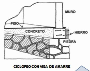
La piedra es el material más empleado en la construcción de cimentación superficial, siempre y cuando ésta sea resistente, maciza y sin poros. Sin embargo, el concreto armado es un extraordinario material de construcción y siempre resulta más recomendable.
