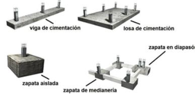
Entre más largos sean los claros, mayor será el peralte de la losa de cimentación. El diseño de este tipo de losa de cimentación es similar al de una losa de entrepiso. Este tipo de cimentación se utiliza comúnmente en la construcción masiva de viviendas por ser un procedimiento rápido y económico.
