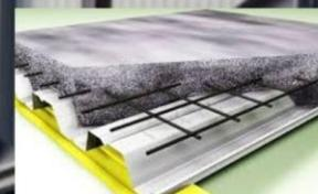
**Placa fácil:** La placa fácil o losa aligerada es un sistema que a pesar de ser muy ligero cuenta con resistencia, está compuesto de piezas de arcilla llamadas bloques, mayormente utilizada en techos o algún tipo de adición a su casa, este tipo de losa está constituida por 4 materiales; el perfil metálico, bloques, la malla electrosoldada y concreto.
