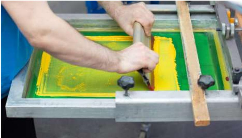
La tinta se aplica de un lado del marco con una racleta de goma, se ejerce presión y con fuerza se distribuye la tinta bajando por toda la malla, en las zonas donde no se debe estampar se coloca un barniz especial para bloquear el paso de la tinta. Esta acción produce una imagen cuando la superficie inferior de la pantalla entra en contacto con el material sobre el que se va a imprimir.
