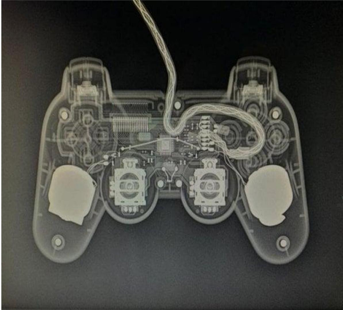
Radiografía de un control de PlayStation, se puede observar el mecanismo interno, los joysticks, la placa y algunos botones.
