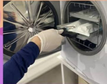
Evacuación del vapor. El vapor se va extrayendo poco a poco y va disminuyendo la presión hasta alcanzar valores negativos.
