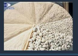
En primer lugar, son los agregados los que, según su procedencia, se dividen en dos grupos: naturales y artificiales. Recordar que el agregado es parte de la mezcla del concreto y ocupan un 75% del volumen cubico del mismo
