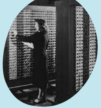
La **EDVAC** (Electronic Discrete Variable Automatic Computer) fue diseñada por este nuevo equipo. Tenía aproximadamente cuatro mil bulbos y usaba un tipo de memoria basado en tubos llenos de mercurio por donde circulaban señales eléctricas sujetas a retardos.
