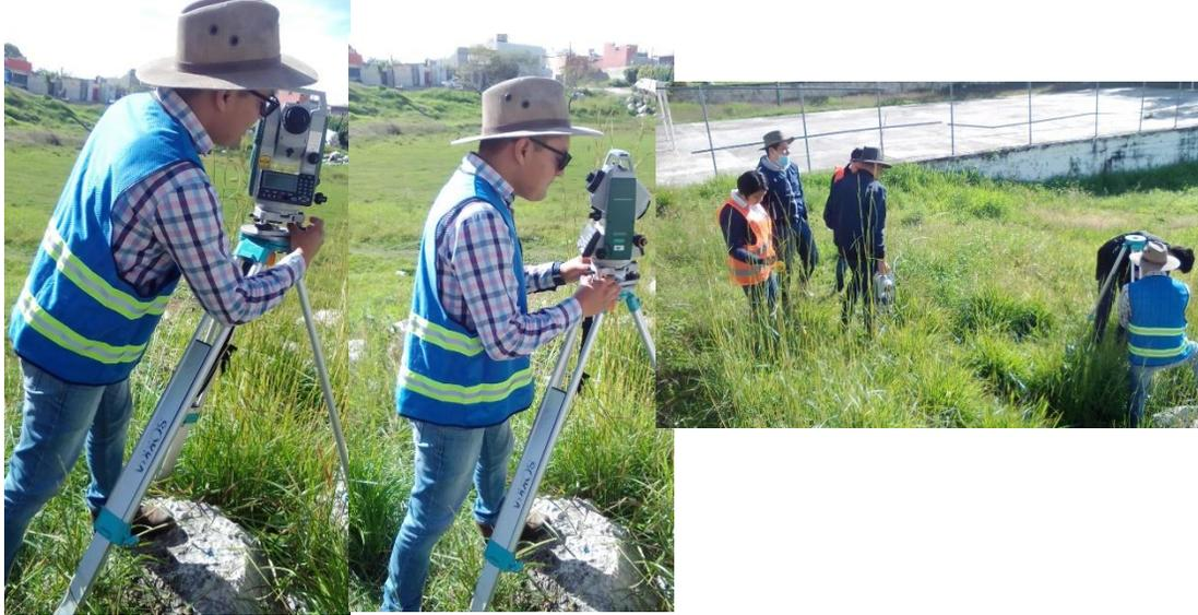
La instalación comienza sacando el equipo, con la base o tripie se centra en un punto de referencia, prosiguiente se saca el equipo y se monta en el tripie.
