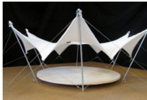
Emplea en gran parte materiales tensados, bien sean membranas textiles, láminas ligeras o mallas de cables, etcétera.
