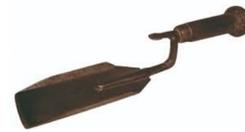
pujavante para herrar. Se trata de una herramienta para cortar con forma de pala y un mango comúnmente de madera. Tiene forma curvada, lo que hace que manejarla sea más fácil.
