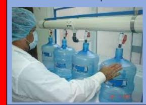
Las boquillas de llenado, así como las válvulas y el maneral deben ser de material sanitario, limpiarse y desinfectarse al inicio de la operación.
