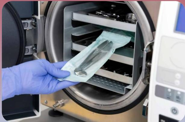
***Como el otro método de esterilización existe el autoclave el cual se cierra herméticamente y en su interior desarrolla vapor bajo presión destruyendo los microorganismos.***
