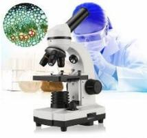
La muestra es iluminada mediante luz visible. Esto significa que existe un foco de luz apuntando hacia la muestra. Esa misma luz es conducida a través del objetivo y del ocular hasta llegar a formar la imagen en el ojo del observador. Este tipo de microscopio más habitual pero su resolución está limitada por la difracción de la luz. El aumento máximo que se puede obtener con este tipo alcanza alrededor de 1500x.
