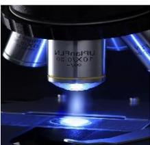
Ilumina la muestra con luz ultravioleta. Este tipo de luz tiene una longitud de onda más corta que la luz visible. Además, el contraste obtenido en la muestra es distinto que, en los microscopios ópticos, con el microscopio de luz ultravioleta se puede observar muestras que aparecen transparentes si son observadas con luz visible.
