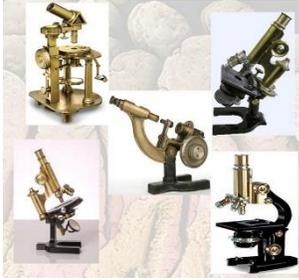
Es un instrumento que permite observar objetos no perceptibles al ojo humano. Se logra mediante un sistema óptico compuesto por lentes, que forman y amplifican la imagen del objeto que se está observando. Este término surge en el siglo XVIII y deriva de las palabras griegas mikros (pequeños) y skopéoo (observar).
