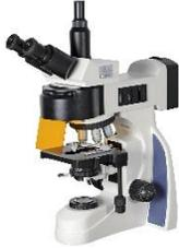
Se utilizan las propiedades de fluorescencia para generar una imagen de la muestra, permite observar sustancias que emiten luz propia cuando son iluminadas con una longitud de onda determinada con una lámpara xenón o una lámpara de vapor de mercurio. Incorporan filtros de luz para aislar la luz correspondiente a la muestra.
