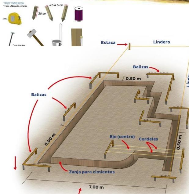
Desde el trazado de la obra es conveniente tener en cuenta a que altura va a quedar el piso interior de la construcción con relación al nivel del terreno y de la banqueta. Es necesario que éste quede más alto que el nivel del terreno para evitar que se meta el agua de lluvia, o que se tengan humedades en los muros. Es por esto que el piso interior debe quedar unos 25 o 30cm, arriba del terreno, y cuando menos 15cm arriba del nivel de banqueta.
