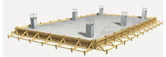
La losa de cimentación es un tipo de cimentación poco profunda que se asemeja a una placa que cubre toda la zona de construcción. Estas son losas de hormigón armado en contacto directo con el suelo que reciben las cargas de los pilares y muros de la superestructura y descargan sobre una gran superficie de suelo.
