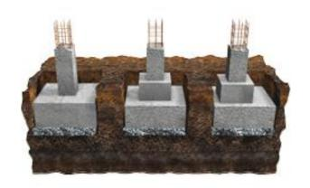
se va a producir algún tipo de asentamiento variable en la construcción. Hay tres tipos de zapatas aisladas: centradas, medianeras y de esquina.
