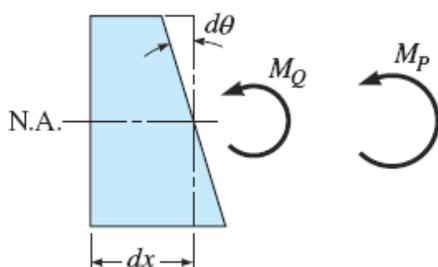
planas *antes* de la flexión permanecen planas *después* de la flexión, y por lo tanto, las deformaciones longitudinales en el elemento varían linealmente desde el eje neutro de la sección transversal. Podemos expresar  $d\theta$  como:
