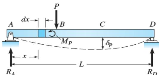
Para calcular la deflexión en el punto C de esta viga, se aplica una carga virtual de 1 kip en ese mismo lugar. La carga virtual genera un momento  $M_Q$  en un elemento típico infinitesimal de longitud  $dx$  de viga.
