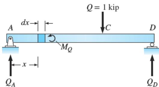
También se muestra un corto segmento de la viga obtenido del miembro sin esforzar, delimitado por dos planos verticales separados una distancia  $dx$ . El elemento se posiciona a una distancia  $x$  desde el apoyo A. Así como las fuerzas del sistema P aumentan, los lados del elemento rotan un ángulo  $d\theta$  debido a los momentos  $M_P$ . Despreciando las deformaciones de cortante (que son bajas en vigas de bajo peralte), asumimos que las secciones
