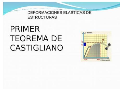
Para terminar el teorema de Castigliano sabemos que permite determinar el desplazamiento en una sección determinada, dado que vendrá dado por la derivada parcial de la energía interna del sistema con respecto a la acción causante del desplazamiento en dicha sección, por otro lado tenemos el método de energéticos esto corresponde a resolver problemas en los que intervienen deflexiones o deformaciones.
