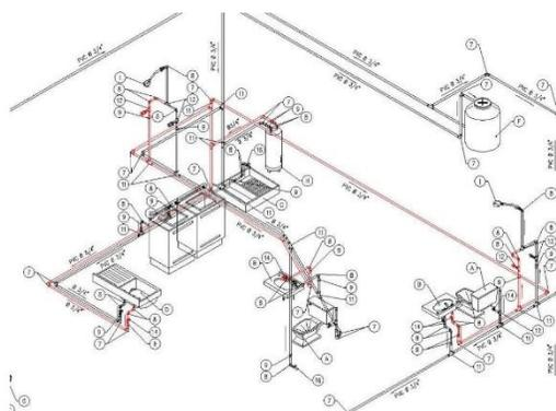
Las instalaciones hidráulicas se pueden definir entonces como el conjunto de tubos, muebles, accesorios (válvulas, codos y conexiones) y equipo (calentadores, bombas, hidroneumáticos) unidos para llevar en forma adecuada el suministro de agua fría y caliente a una edificación.
