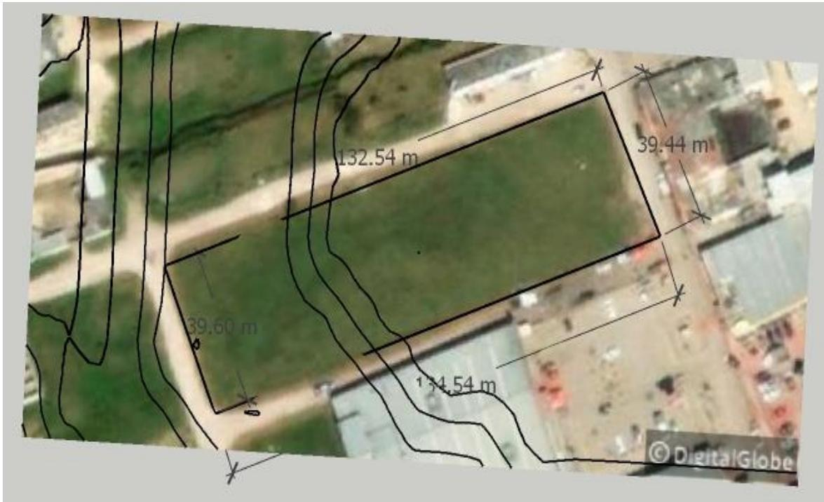
La imagen representa el predio que se localiza a un lado de soriana, en el cual se fue a un levantamiento sin el uso de estación total o teodolito. En donde al tener las dimensiones del perímetro facilito el trazo en sketchup y AutoCAD, así como también realizar la curva de nivel del terreno y así saber el desnivel en el que se encuentra para poder ejecutar el proyecto arquitectónico.
