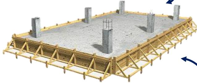
Es conjunto de elementos estructurales de una estructura, transmite sus cargas o elementos apoyados en ella al suelo
