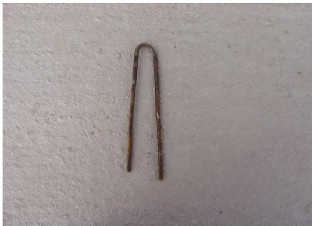
Coloca grapas para fijar la malla electrosoldada.
