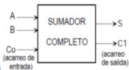
Fig. 3 Diagrama a bloque y tabla de verdad de un sumador completo
