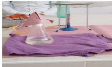
3. Se colocó el matraz en el mechero hasta que el contenido estuviera en su punto de ebullición es decir cuando ya empezara a burbujear para así poder colocarlo sobre el papel estroza hasta que se enfriara.
