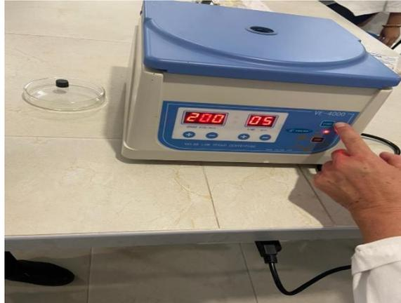
Una vez ya cuantificada la muestra rellenamos en el tubo de ensayo aproximadamente a la mitad, las tapamos y las ponemos en el centrifugador por lo consiguiente esperamos de 5 a 7 minutos.
