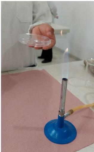
Procedimos a sacar las cajas Petri de la bolsa para poder agregar la mezcla en ellas, así que tomamos uno, colocándolo cerca del mechero, como a 15 cm de distancia para no contaminar.
