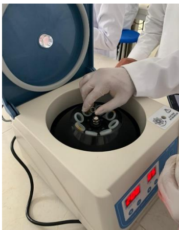
Introduccion de los tuvos de ensayo a la centrifugadora
