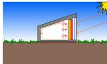
Muro de acumulación no ventilado
