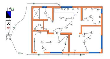
Un plano eléctrico es la representación de los diferentes circuitos que componen y definen las características de una instalación eléctrica y donde se detallan las particularidades de los materiales y dispositivos existentes.
