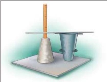
El revenimiento es la medida de la consistencia del concreto fresco en términos de disminución de altura.
