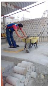
En segunda esta la prueba de resistencia, esto sucede en un envase cilíndrico, en tres capas, igual se le hacen 25 penetraciones y al último se golpea alrededor para sacarle el aire, esperar a que se seque o este compacto para dar el siguiente paso.
