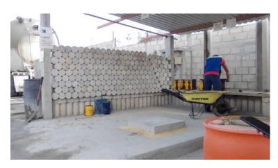
Una vez que este seco este entra a una prueba de compresión, dentro de una maquina hidráulica, pero antes se le pone una capa de azufre en ambas caras del cilindro para que durante compresión este se aplane sus caras. Después se le mete en agua en un tanque, para hacer las pruebas de 7, 14 y 28 días, para ver que resistencia alcanza
