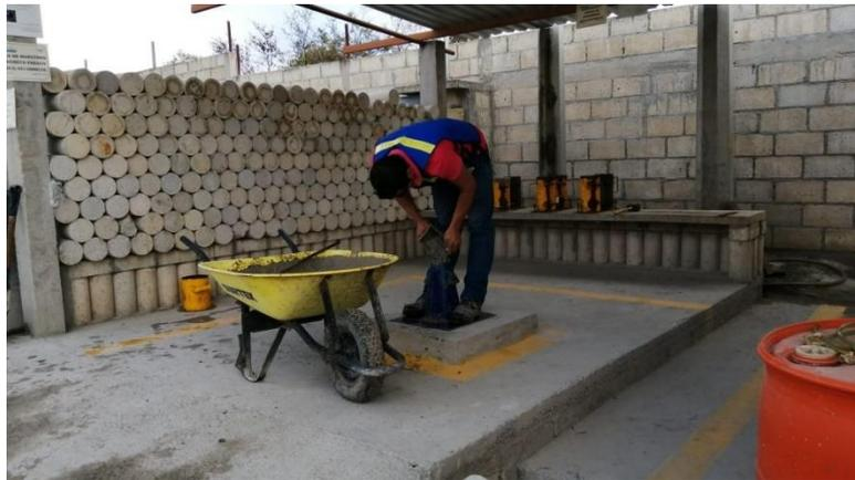
En el siguiente procedimiento de igual manera es la prueba de revenimiento esto servirá si la cantidad de cemento que pido el cliente va completa, consiste en poner el concreto en un recipiente el cual lleva 3 capas y 75 penetraciones.
