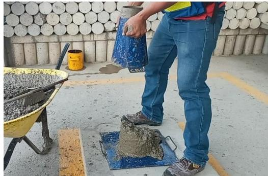
El llenado del cono se hace en tres capas, cada capa tiene que llevar 25 perforaciones en modo de espiral, para no dejar vacíos dentro del cono. Al momento de levantar el cono, esto se hace en un tiempo de 5 segundos exactamente, ya que al no respetar este tiempo alteraría los resultados del revenimiento.
