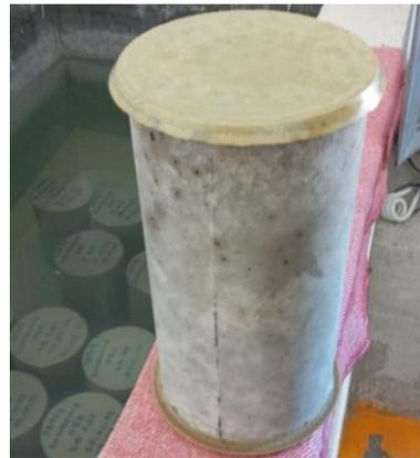
Los resultados de las pruebas de resistencia a partir de la elaboración de cilindros, se pueden utilizar para fines de control de calidad, aceptación del concreto o para estimar la resistencia del concreto en estructuras, permitiendo programar las operaciones de construcción, tales como remoción de formaletas (cimbras) o para evaluar la conveniencia de curado y protección suministrada a la estructura.
