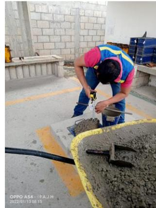
Otra prueba de resistencia es la de la masa unitaria, en esta, se emplea un cubo es la misma forma de llenado, se rellena en tres partes y en cada relleno se le vuelve a hacer las 25 penetraciones, lo que cambia de la anterior es que en esta se le da golpes, ya que en ocasiones le puede quedar aire, en esta para comprobar la resistencia se pesa y con eso se hacen determinados calculos y con eso se sabe la resistencia de el concreto.
