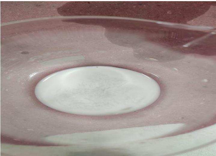
Después proseguimos con la leche y ya una vez aplicando el ácido cítrico esta estructura láctea se comenzó a deformar, rompiendo los enlaces y estructura proteica.
