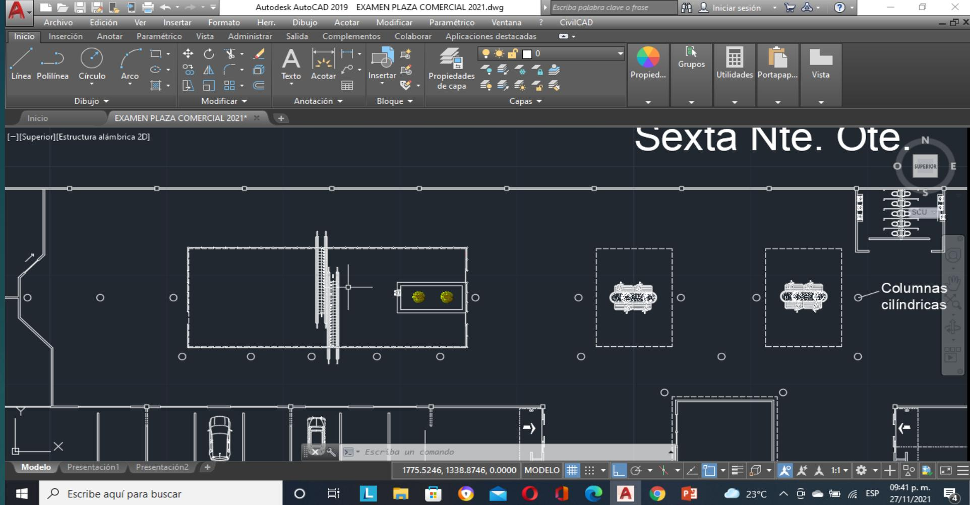
Los puntos que se aprecian en plano, represente son columnas representadas de esa forma, con dimensión de 60 cm de diámetro, esto para la primera planta.
