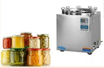
El proceso de esterilización en los productos en conserva se puede subdividir en tres fases por medio de vapor
