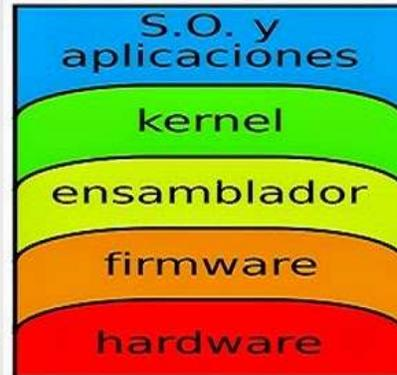
Una visión típica de una arquitectura de computadora como una serie de capas de abstracción: hardware, firmware, ensamblador, kernel, sistema operativo y aplicaciones.
