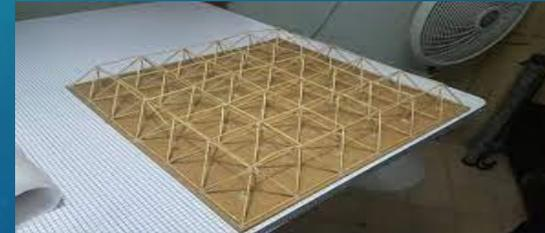
SUJETADOS POR MEDIO DE LOS NODOS CON BOLITAS DE UNICEL O PLASTILINA PARA CREAR UNA TRAILDILLOS DE VECTOR ACTIVO
