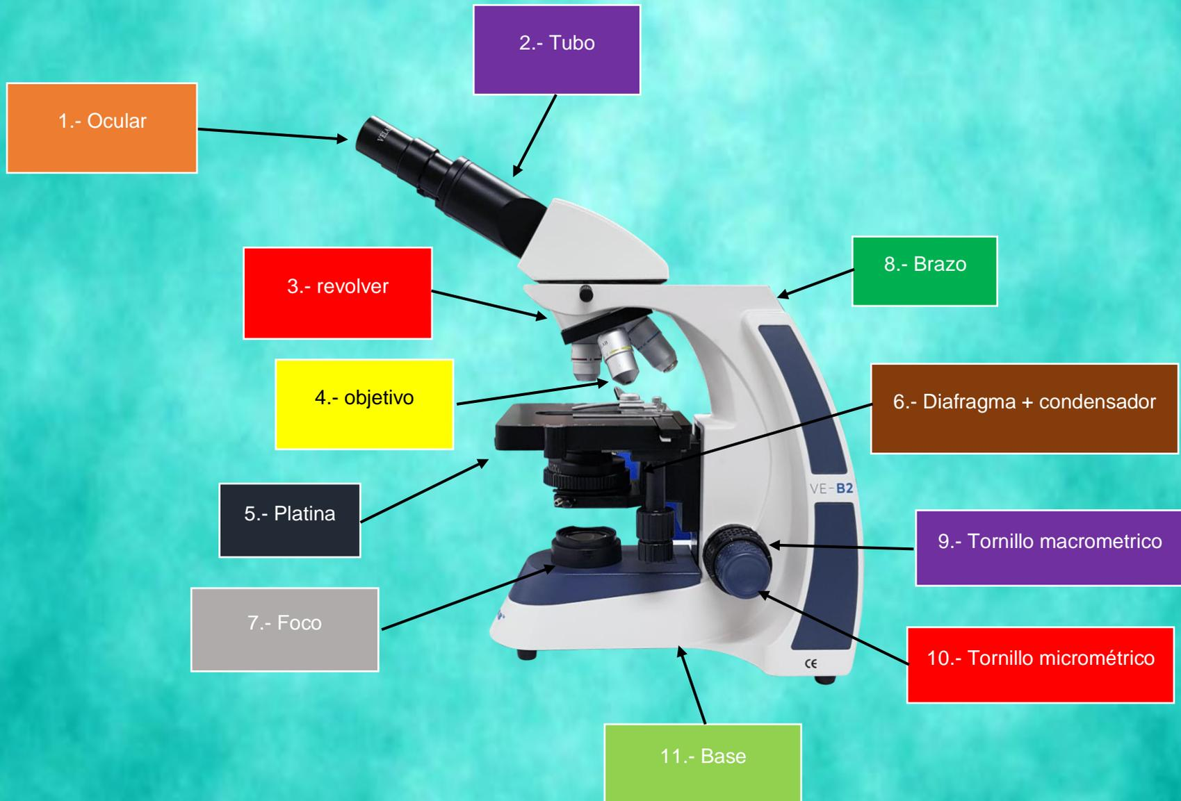
**1.- El ocular:** amplía la imagen que ha sido previamente aumentada mediante el objetivo. En general, el aumento aportado por el ocular es inferior al del objetivo. Es a través del ocular que el usuario observa la muestra.
