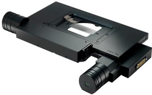
**5.- Platina:** Esta es la superficie donde se coloca la muestra que se quiere observar. Su posición vertical con respecto a las lentes del objetivo se puede regular mediante dos tornillos para generar una imagen enfocada.
