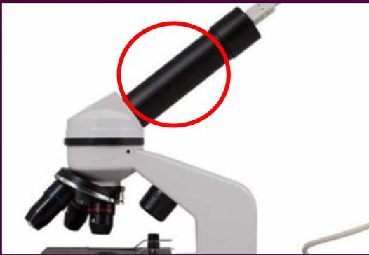
**2.-Tubo:** El tubo es una pieza estructural unida al brazo del telescopio que conecta el ocular con los objetivos. Es un elemento esencial para mantener una correcta alineación entre los elementos ópticos.
