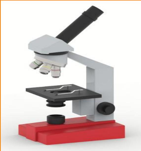
11.- **Base o pie:** Es la pieza que se encuentra en la parte inferior del microscopio y sobre la cual se montan el resto de elementos. Acostumbra a ser la parte más pesante para proporcionar suficiente equilibrio y estabilidad al microscopio.
