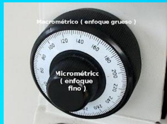
10.- Tornillo micrométrico: El tornillo micrométrico se utiliza para conseguir un enfoque más preciso de la muestra. Mediante este tornillo se ajusta de forma lenta y con gran precisión el desplazamiento vertical de la platina.
