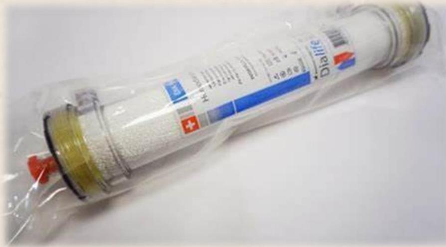
La esterilización se lleva a cabo con formol al 5%, lo cual se considera un proceso químico que inactiva todos los microorganismos vivos, ya que el vapor del formaldehído es efectivo para desinfectar las fibras que inadvertidamente no llegan a ponerse en contacto con el formaldehído líquido.
