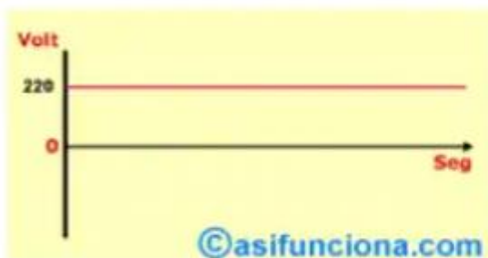
Gráfico de una corriente directa (C.D.) o continua (C.C.).
